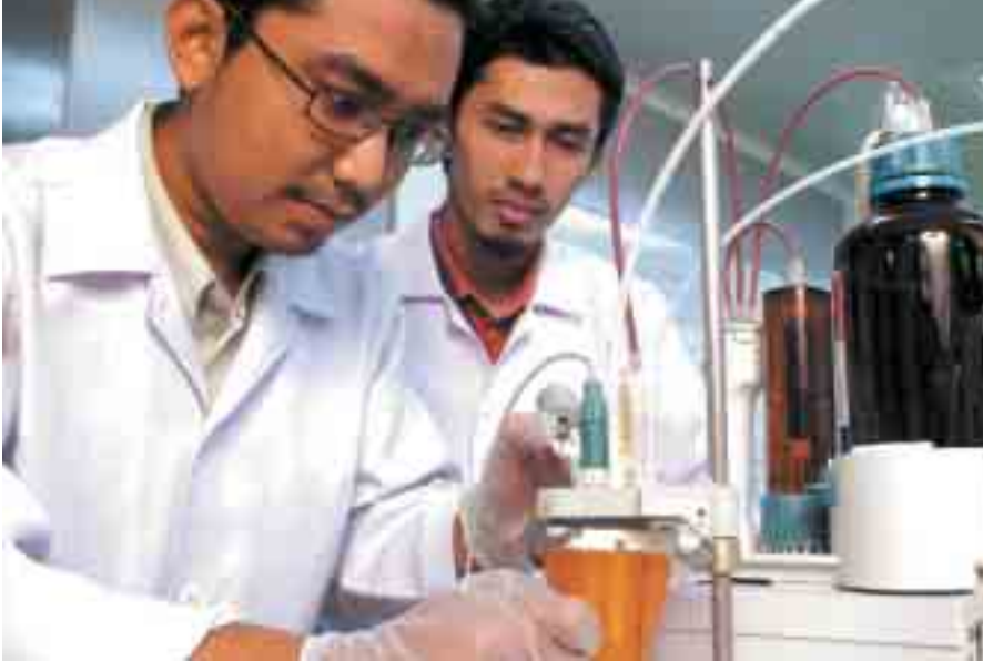
Laboratory analyst conducting the water content test using the Karl-Fischer apparatus. Analisis makmal menjalankan ujian kandungan air menggunakan alatan Karl-Fischer.
