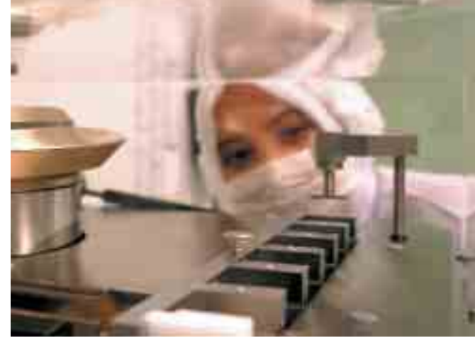
Technician checking weight, diameter, hardness and thickness of tablets to the set specifications using the automatic tablet tester as part of the in-process quality control checks of the product. Juruteknik memeriksa berat, garis pusat, kekerasan dan ketebalan tablet berbanding spesifikasi yang ditetapkan menggunakan alat pengujian tablet automatik sebagai sebahagian daripada proses pemeriksaan kawalan kualiti produk.
