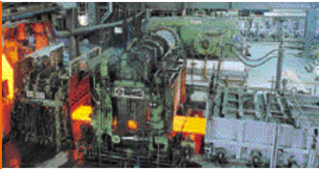
Thin slab continuous caster at Megasteel to produce ultra-thin slabs. Acuan 'slab' nipis di Megasteel untuk mengeluarkan slab ultra-nipis.
