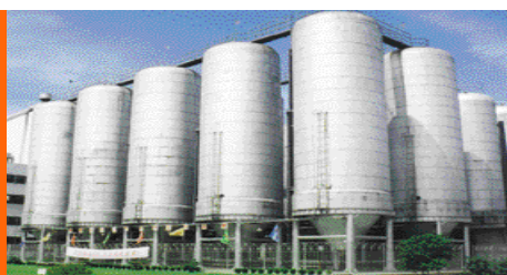
Beer fermentation tanks at one of the Group's breweries in China. Tangki penapaian bir di salah satu kilang bir Kumpulan di China.
